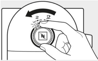
3. Ruota la manopola finché la spia lampeggiante non si trova nella prima posizione a destra.
