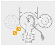
2. Rimuovi il serbatoio dell'acqua e il contenitore delle capsule per pulirli;
