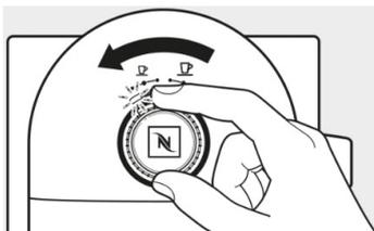
3. Ruota la manopola finché la spia lampeggiante non si trova nella prima posizione a destra.
